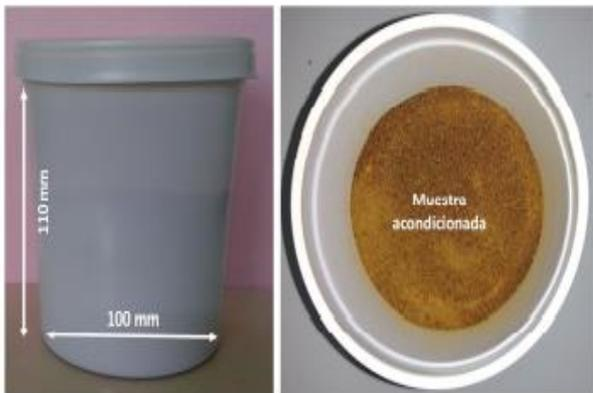
Muestra acondicionada en recipiente de ensayo
