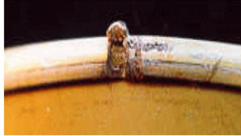
**i) Rayas o marcas.**- Es considerado **defecto serio**. Aguda deformación lineal de la lámina de metal en el interior o exterior del envase, de forma que la lámina es fracturada o existe riesgo potencial de fractura debido al manipuleo.
