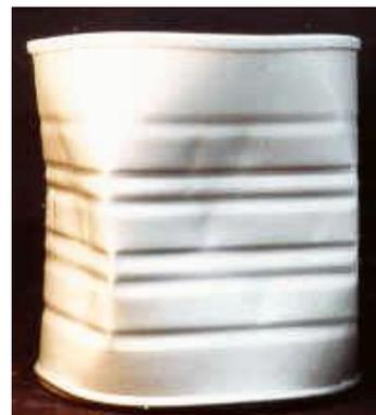
**l) Magulladuras.-** Defecto serio. Deformación mecánica extrema del envase.
