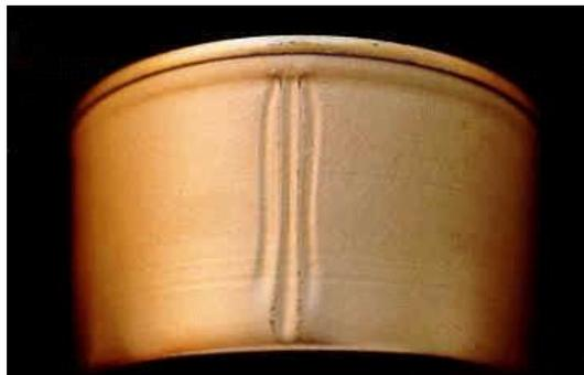
d) **Fractura de perfil de fondo.-** Es considerado **defecto serio** cuando hay una fractura completa del radio del avellanado o el radio del avellanado está debilitado lo suficiente como para fracturarse.
