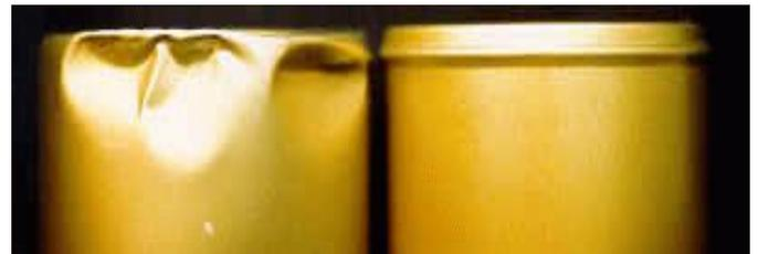
**k) Cuerpo hundido o aplanado.**- Es considerado defecto serio cuando la deformación del cuerpo ocasiona la rotura del barniz interior, o el doble cierre o la costura lateral han sido deformados.
